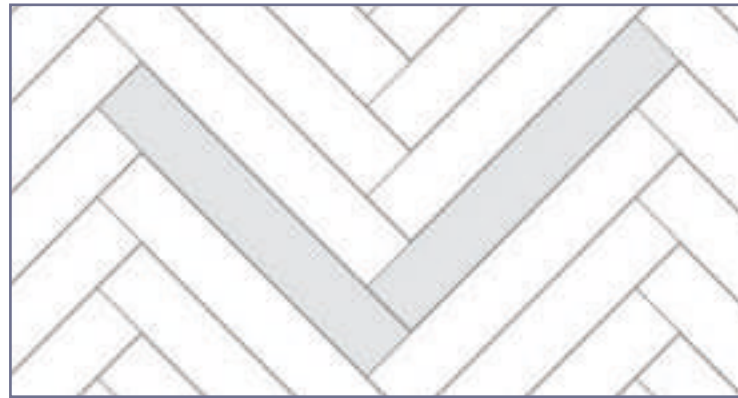
Colocación en espiga
