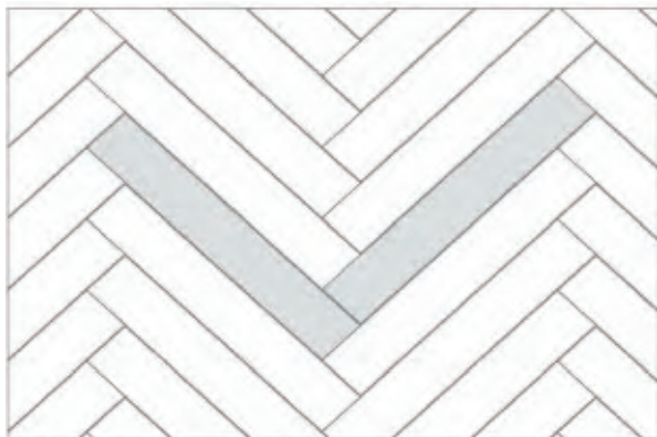
COLOCACIÓN EN ESPIGA
