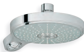
27 764 000 Верхний душ 190 4 режима струи: GROHE Rain O 2 , Rain, Vokoma Spray™, Jet 27 765 000 / 27 765 ENO с ограничителем расхода воды 9,4 л/мин.
