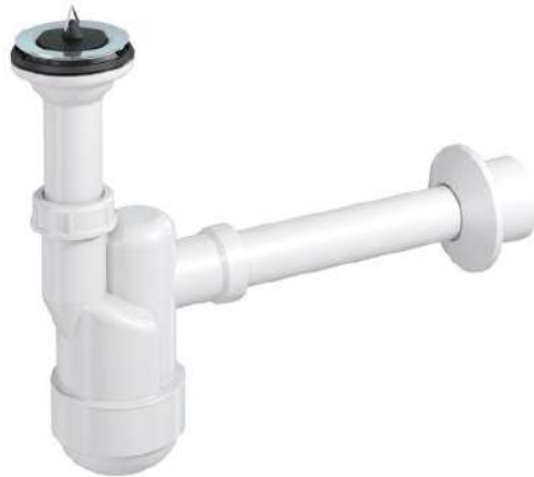
Сифон для умивальника Ventloc, з кулькою всередині (сухий затвор), традиційна гумова пробка, зливна телескопічна трубка d32/50 з розеткою
