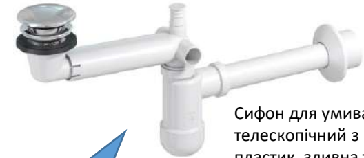
Сифон для умивальника Preloc телескопічний, гумова заглушка, зливна трубка d32/50 з розеткою, підключення до пральної машини та переливу
