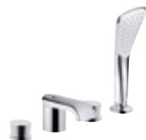
Wannenfüll- und Brausearmatur DN 15 für Vierloch-Wannenrandmontage Ausladung 110 mm 554240505 55424H705
