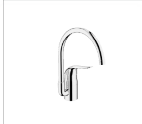
32 786 000 Euroeco Special Смеситель однорычажный для раковины, DN 15, Монтаж на одно отверстие, ламинарный регулятор струи 9 л/мин., поворотный трубообразный излив, металлический рычаг 120 мм
