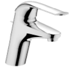
32 766 000 Euroeco Special Смеситель однорычажный для раковины, DN 15 монтаж на одно отверстие, ламинарный регулятор струи 9 л/мин., металлический рычаг 120 мм, сливной гарнитур
