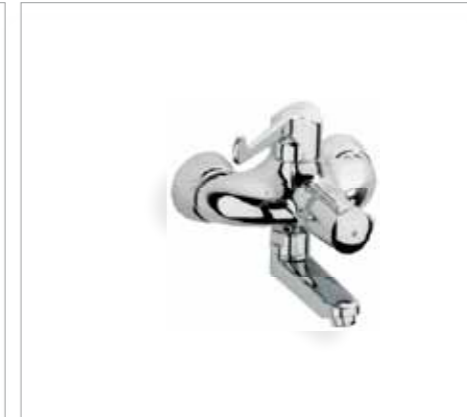
34 019 000 Grohtherm Ergomix Термостат для раковины, DN 15, с локтевым управлением, металлический рычаг 250 мм, рукоятка выбора температуры с предварительно устанавливаемым стопором безопасности, термическая дезинфекция, вынос 178 мм
