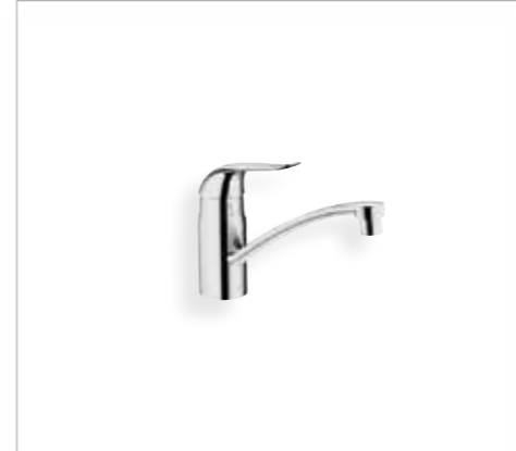
32 787 000 Euroeco Special Смеситель однорычажный для мойки, DN 15, монтаж на одно отверстие, регулировка расхода воды, поворотный трубообразный излив, возможность установки мин. расхода 2,5 л/мин., металлический рычаг 120 мм, ограничитель температуры
