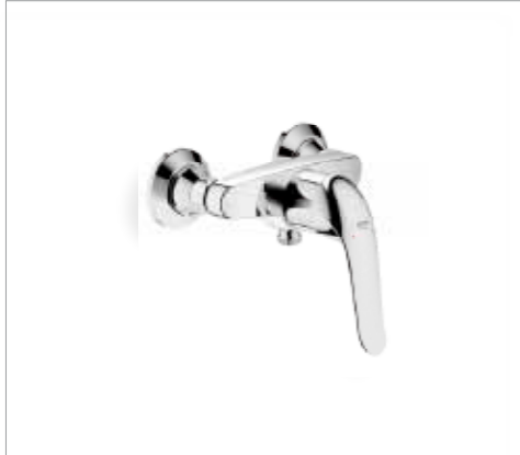
32 781 000 Euroeco Special Смеситель однорычажный для душа, DN 15, настенный монтаж, отвод для душа снизу 1/2", встроенный обратный клапан, регулировка расхода воды, металлический рычаг 120 мм, с запорными S-эксцентриками
