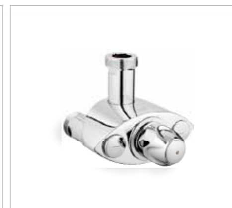
35 087 000 Grohtherm XL Термостат, DN 32, рукоятка выбора температуры с предварительно устанавливаемым стопором безопасности, отвод изменяемый сверху/снизу
