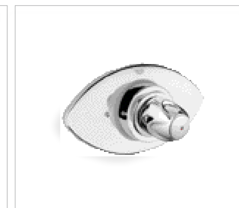
35 003 000 Grohtherm XL Термостат, DN 25, рукоятка выбора температуры с предварительно устанавливаемым стопором безопасности, резьба подключений 1 1/4", отводная резьба 1 1/4"
