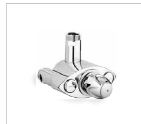
35 085 000 Grohtherm XL Термостат, DN 25, настенный монтаж, рукоятка выбора температуры с предварительно устанавливаемым стопором безопасности, резьба подключений 1 1/4", отводная резьба 1 1/2"
