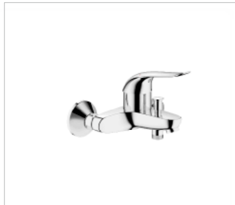
32 783 000 Euroeco Special Смеситель однорычажный для душа, DN 15, настенный монтаж, регулировка расхода воды, автоматический переключатель: ванна/душ, встроенный обратный клапан, металлический рычаг 120 мм
