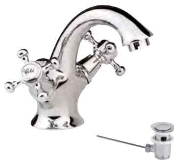
38970 Mezclador de lavabo con desagüe automático Enlaces de alimentación flexible de 3/8" Montura cerámica 1/4 vuelta
