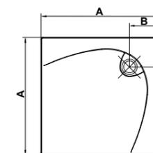
69855 ARQ. de 80 x 80 cm. extraplano. 3 cm. de altura con válvula de desagüe de 90 mm.
