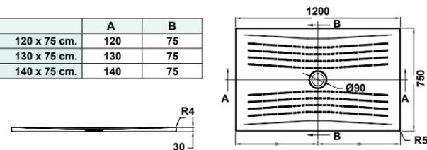
63065 S-LINE 120 x 75 cm. extraplano con válvula de desagüe de 90 mm.
