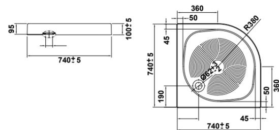
63940 ORBIT de 75 x 75 cm. 10 cm. de altura sin válvula de desagüe.
