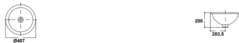
04220 Lavabo de encimera JARA de 40 cm. ø. Con rebosadero. Sin orificio de grifería
