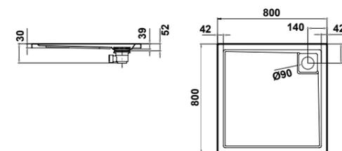
63925 SIGMA de 80 x 80 cm. extraplano. 3 cm. de altura con válvula de desagüe de 90 mm.
