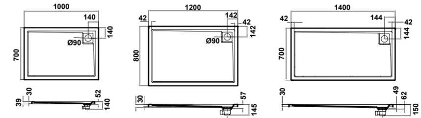
63927 SIGMA de 100 x 70 cm. extraplano de 3 cm. de altura con válvula de desagüe de 90 mm.
