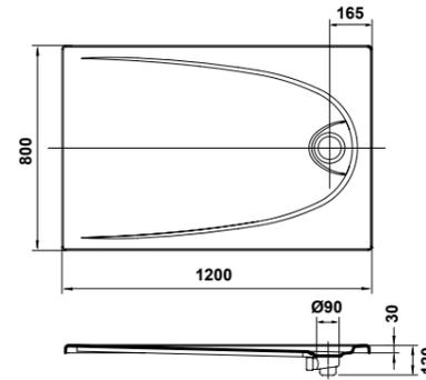
69853 ARQ. de 120 x 80 cm. extraplano. 3 cm. de altura con válvula de desagüe de 90 mm.
