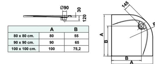
69854 ARQ. de 80 x 80 cm. angular extraplano. 3 cm. de altura con válvula de desagüe de 90 mm.
