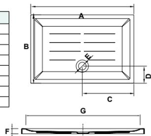
63951 VITA 100 x 80 cm. 5 cm. de altura con válvula de desagüe de 90 mm.
