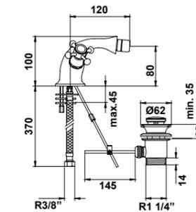
38971 Mezclador de bidé con desagüe automático
