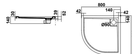
63926 SIGMA de 80 x 80 cm. angular extraplano. 3 cm. de altura con válvula de desagüe de 90 mm.
