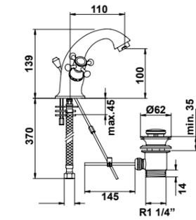
38970 Mezclador de lavabo con desagüe automático
