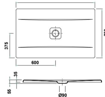
63943 LINE 120 x 75 cm. 3,5 cm. con válvula de desagüe de 90 mm.
