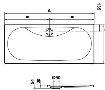
69861 ATOS - PLUS de 160 x 70 cm. extraplano, 3,5 cm. de altura con válvula de desagüe de 90 mm.
