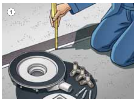
1 Измерить высоту напольной конструкции, здесь: 85 мм.
