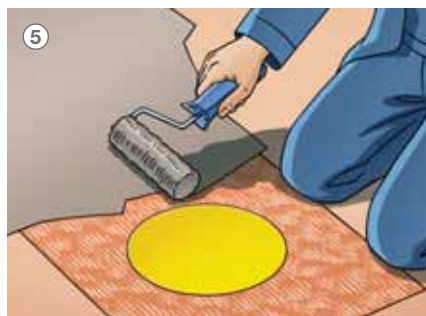
5 Положить уплотнительную манжету Schluter-Kerdi в предварительно нанесенную жидкую изоляцию.
